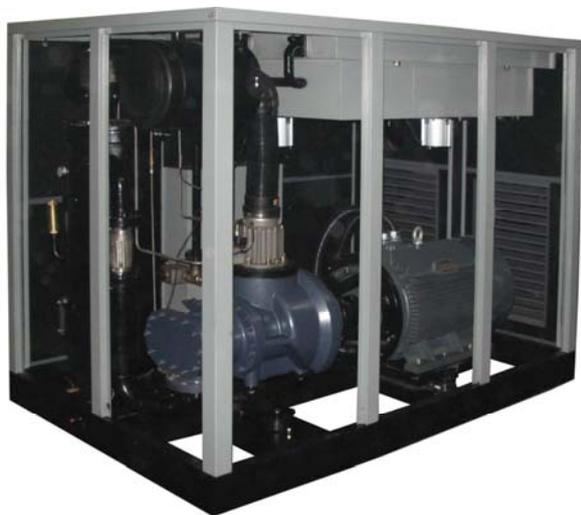
Компрессорные установки модификации М2 являются продолжением винтовых воздушных компрессоров серии 2ВВ модификации М1. Основным критерием создания компрессорных установок модификации М2 явилось снижение себестоимости изготовления за счет оптимизации конструкции компрессорных установок в целом значительно повлиявшее на снижение отпускной цены.
