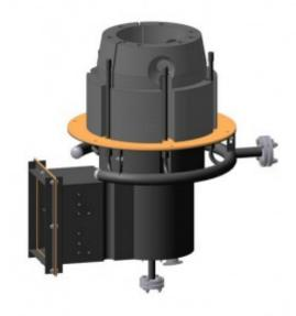
Горелки принадлежат к классу горелок с низкими выбросами оксидов азота, номинальной тепловой мощностью 1,6; 3,5; 5,0; 6,3 МВт, предназначенных для сжигания газового топлива в трубчатых печах и других нагревательных установках и агрегатах нефтеперерабатывающей, нефтехимической и газовой промышленности.
